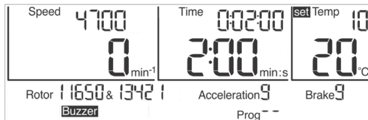
Abb. 19: Einstellen der Solltemperatur
