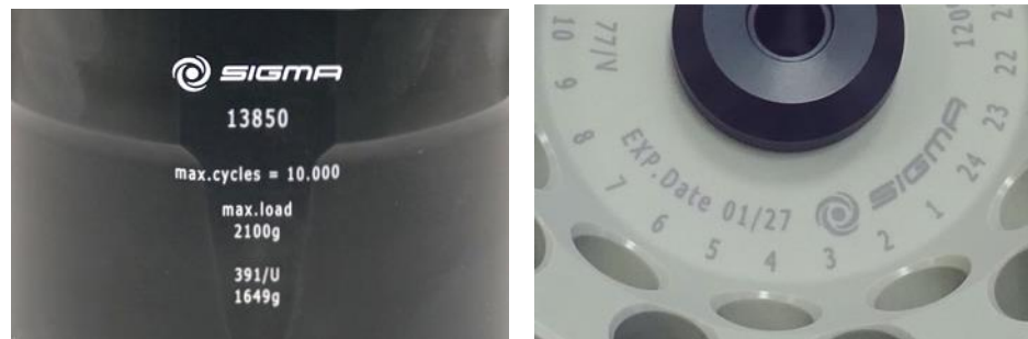
Abb. 5: abweichende Lebensdauer – Gravur auf dem Becher / Rotor (Beispiele)
