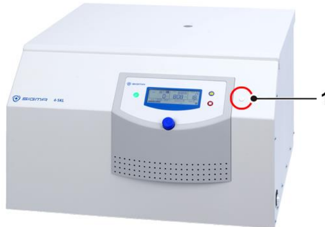
Abb. 34: Position der Öffnung für die Notentriegelung
