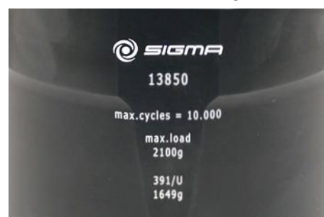
Abb. 6: abweichende Lebensdauer – Gravur auf dem Becher / Rotor
