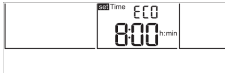
Abb. 30: Anzeige der Abschaltzeit
