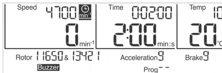
Abb. 16: Die Funktion "Laufzeit ab Solldrehzahl" ist aktiviert
