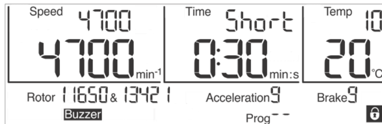
Abb. 18: Anzeige "Short" während des Kurzzeitbetriebs
