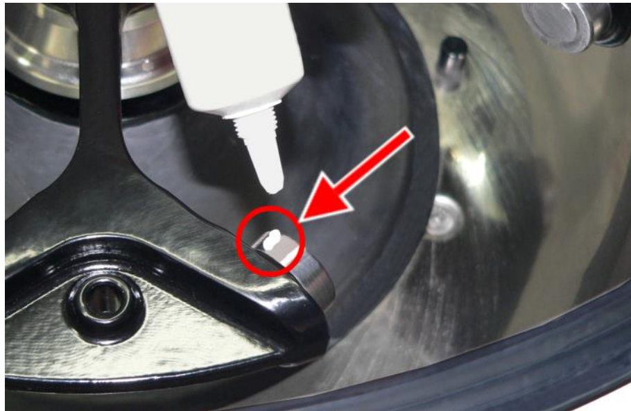
Abb. 36: ausreichende Menge Tragbolzenfett für einen Bolzen
