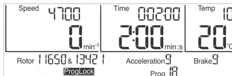
Abb. 25: Die Programmsperre "ProgLock" ist aktiviert
