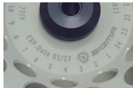
Abb. 6: abweichende Lebensdauer – Gravur auf dem Becher / Rotor
