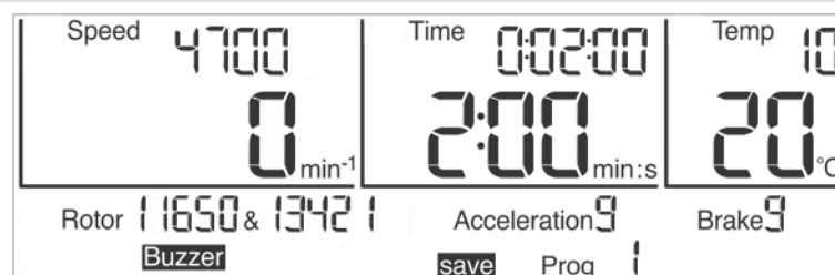
Abb. 32: Speichern eines Programms
