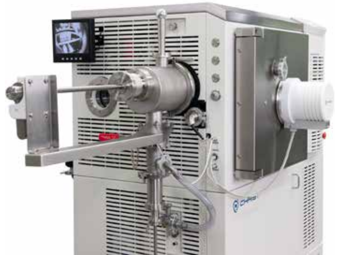
Beispiel: Probenentnahmesystem/Manipulator mit Kamera und zusätzlich LyoCam in der Tür zur Prozessdokumentation.
